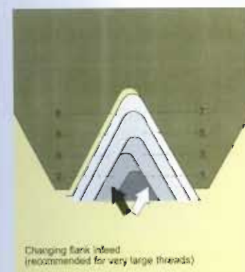
تغییر بار جناحی (برای پیچهای خیلی بزرگ توصیه شده)
