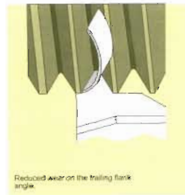
کاهش سایش روی جناح عقب زاویه تقلیل یافته
